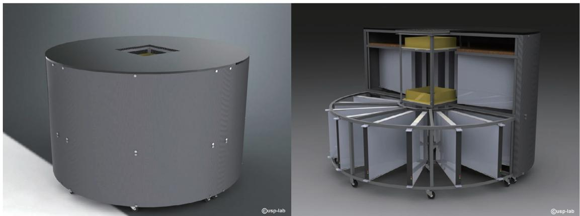
図2. 26 台ものコンピューターから構成されたエクストリームなマシン
