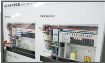
石狩DCの外気冷房は壁吹き出し方式と天井吹き出し方式の2種類で、取り入れた外気をサーバールームの壁から真横に送り出すか、天井から送り出すかの違いがあります。
